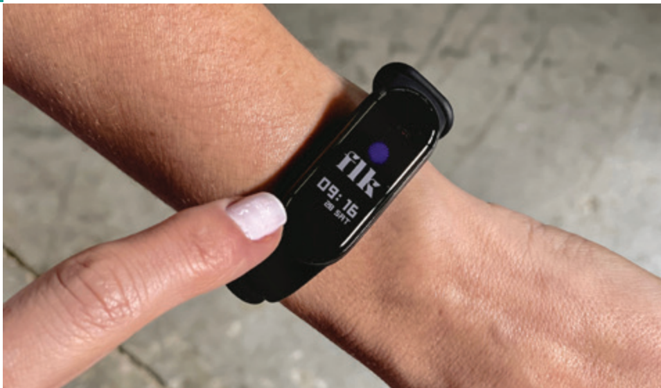
Operador recebe avisos no relógio/pulseira em caso de problema ou fim do ciclo da máquina
